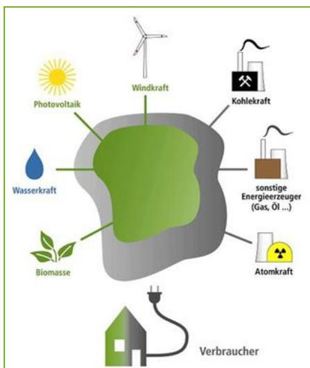
Der „Stromsee“ enthält elektrischen Strom jeder Art, regenerativ wie konventionell erzeugten. Ihm wird so viel Strom entnommen, um den Bedarf der Kunden zu decken. Gleichzeitig muss genau diese Menge wieder eingespeist werden, um den „Wasserspiegel“ konstant und das Stromnetz stabil zu halten.
