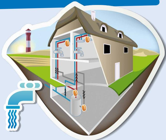
Schematische Darstellung einer Installation mit Probeentnahmestellen gemäß DVGW-Arbeitsblatt W551. Je nach Umfang der Hausinstallation sind mindestens drei oder mehr Probeentnahmestellen
