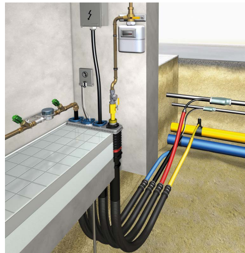
Abbildung: All inclusive ohne Keller, Einbau Quelle:Doyma
