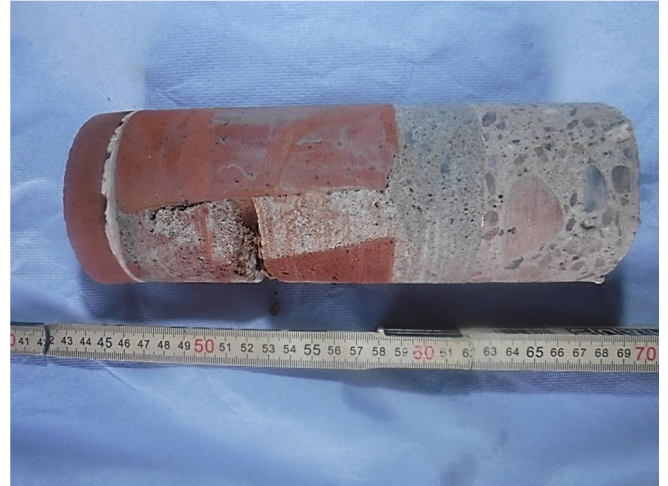
Abb. 14: Bohrkern aus Untersuchungsstelle Fußbodenaufbau Überdachung Vorlagebehälter
