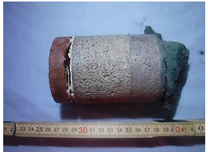
Abb. 16: Bohrkern aus Untersuchungsstelle Fußbodenaufbau Betriebsraum
