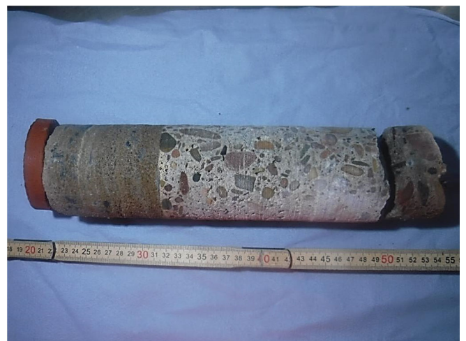
Abb. 18: Bohrkern aus Untersuchungsstelle Fußbodenaufbau Pumpenraum UG
