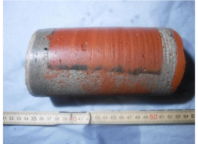
Abb. 8: Bohrkern aus der Untersuchungsstelle Wand im Vorlagebehälter
