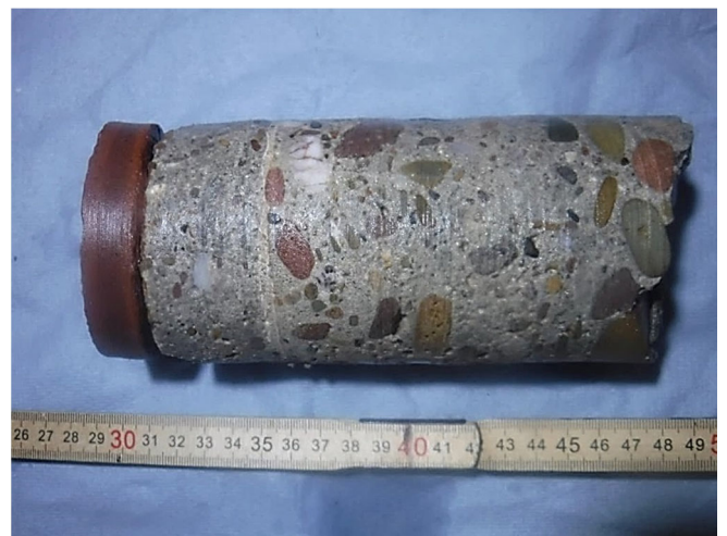
Abb. 12: Bohrkern aus Untersuchungsstelle Fußbodenauf- bau Zwischensohle Vorlagebehälter
